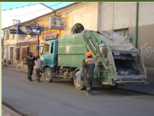
Oruro, carro compactador de cap. Aprox. 10 m 3
