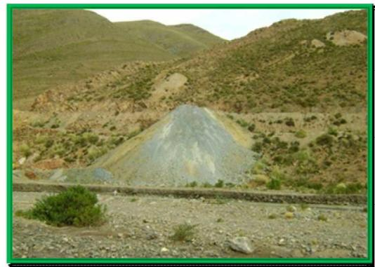
Foto 4. Inadecuada disposición de desmontes a la intemperie. Microcuenca Poopó.
