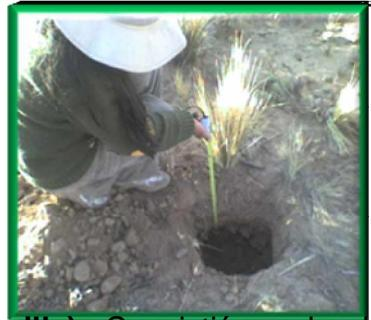
Foto 12. Medición de la profundidad efectiva del suelo con ayuda del flexómetro.
